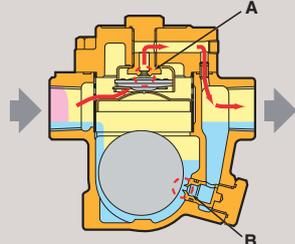
Cuando la trampa está fría, el elemento X está contraído y el puerto de la válvula (A) abre completamente descargando continuamente el aire inicial. Tan pronto como el condensado frío entra en la trampa, el flotador se eleva para permitir la descarga por el puerto (B) y el aire y condensado por el puerto (A).
