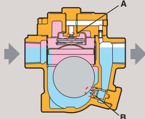
Una vez que todo el condensado y aire inicial fueron descargado, el condensado caliente calienta el elemento X y cierra el puerto (A) antes que el vapor pueda escapar. El condensado que simultáneamente ingresa a la trampa es descargado continuamente por el puerto (B)
