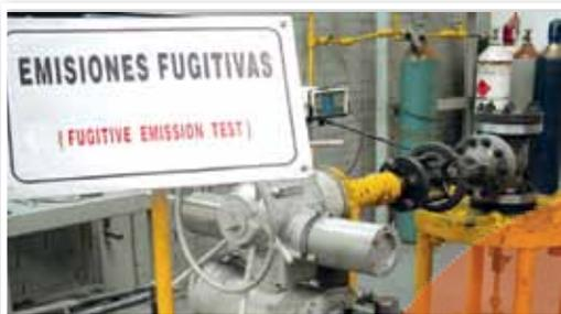
**Equipo de Pruebas de Bajas Emisiones Fugitivas.**- Se aplica cuando un cliente requiere un Certificado de Bajas Emisiones Fugitivas. El laboratorio tiene su propio equipo LFE capaz de medir menos de 20 ppm en condiciones estáticas o dinámicas, a temperatura ambiente o bajo condiciones de operación de ciclos térmicos.
