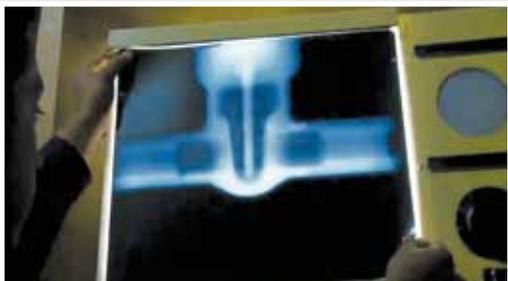
**Equipo para Examinación Radiográfica.**- WALWORTH cuenta en sus instalaciones con su propia fuente de Iridio Ir-92, para pruebas de radiografía a las fundiciones desde 0.100" hasta 2 1/2" de espesor de pared, verificando la sanidad de las materias primas.
