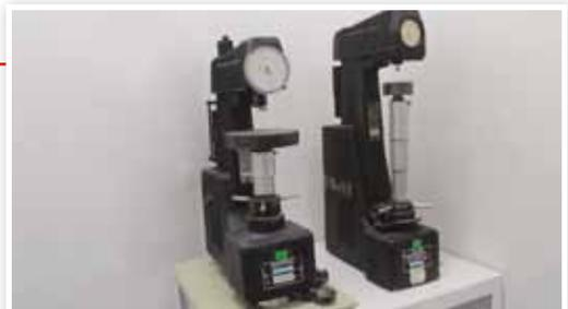
**Equipo de Dureza.**- Tanto para pruebas en laboratorio y planta, WALWORTH cuenta con equipos de prueba Rockwell B, C, Brinell y Vickers para verificar el cumplimiento de los requerimientos de dureza que exigen las normas.
