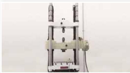
**Equipo de Prueba de Tensión.**- Para asegurar las propiedades mecánicas de los materiales empleados en la fabricación, WALWORTH realiza pruebas por muestreo de probetas de materias primas provenientes de nuestros proveedores, aún cuando se reciban certificaciones de calidad de las mismas.
